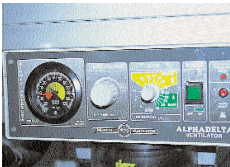
Fotografía 6. Cuadro de mandos de un ventilador de concertina. La regulación del volumen se ajusta observando el manómetro incorporado.
