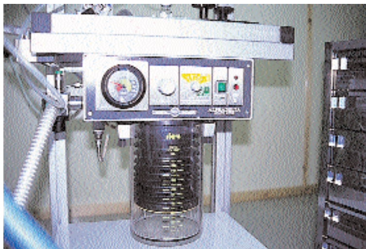
Fotografía 5. Ventilador de concertina. El manómetro en el cuadro de mandos permite conocer la presión en vías aéreas. La cantidad de mezcla inyectada es determinada observando el descenso de la concertina sobre la regleta serigráfica en la caja de plástico transparente que la contiene.
