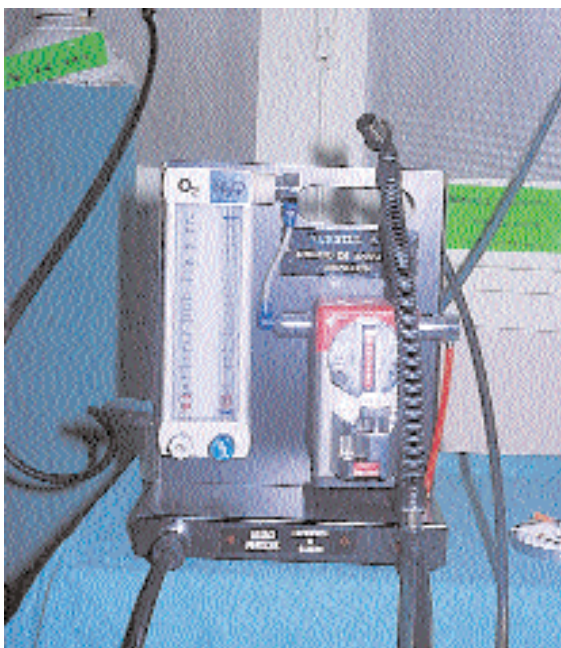
Fotografía 10. Rotámetros de oxígeno (izquierda) y óxido nitroso (derecha) de la máquina anestésica.
