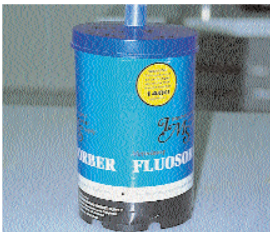
Fotografía 17. Filtro de carbón activado conectado a la válvula de descarga mediante una manguera. Muy aconsejable si no se dispone de salida exterior.
