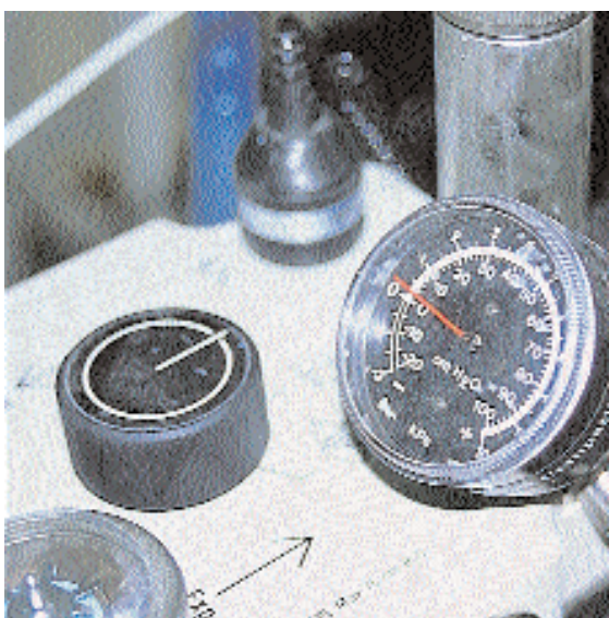
Fotografía 28. Manómetro del circuito circular para medición de la presión en vías aéreas.
